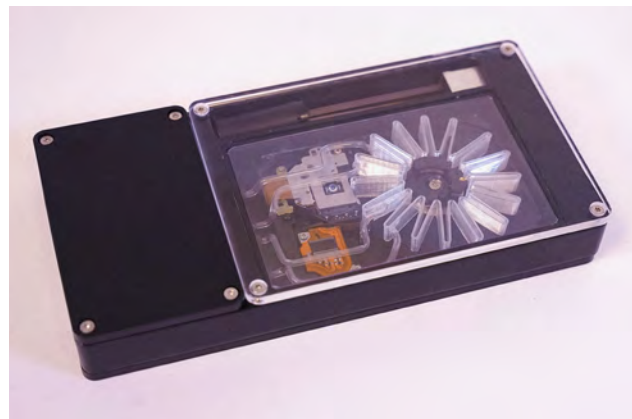
Figura 10 a) Uma plataforma de biomineralização. b) Cartuchos de biomineração que coletam materiais de terra-rara para biomineração comunitária. Imagens de Vahidi et al., (2118)
